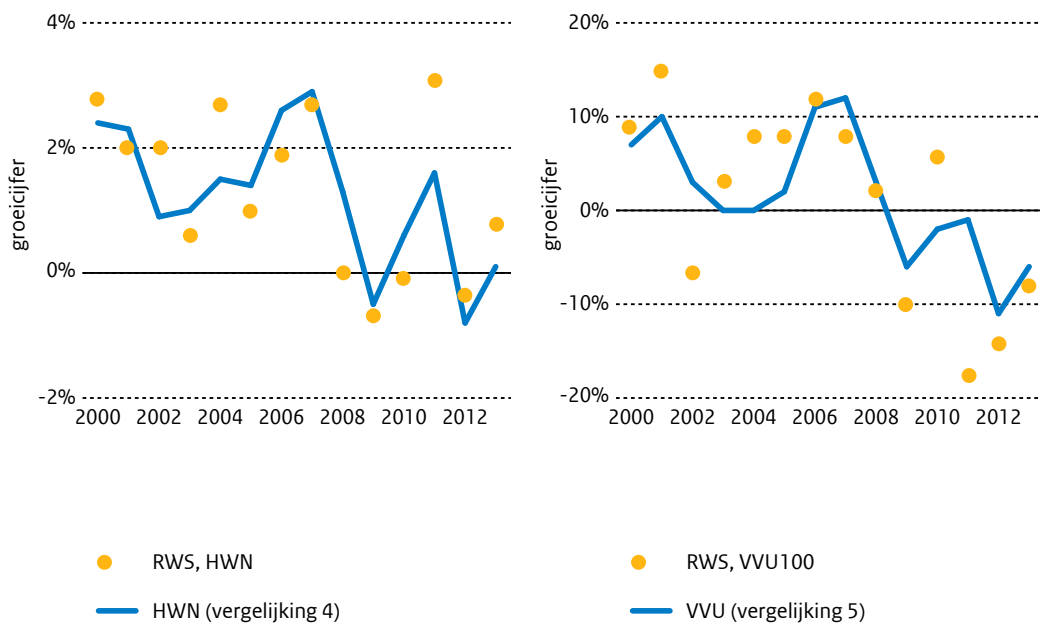
Figuur 1 Groeicijfers. Bollen: RWS-cijfers, lijn: modelschatting Links: Verkeersprestatie op het hoofdwegennet (vergelijking 4) Rechts: Reistijdverliezen op het hoofdwegennet (vergelijking 5)
